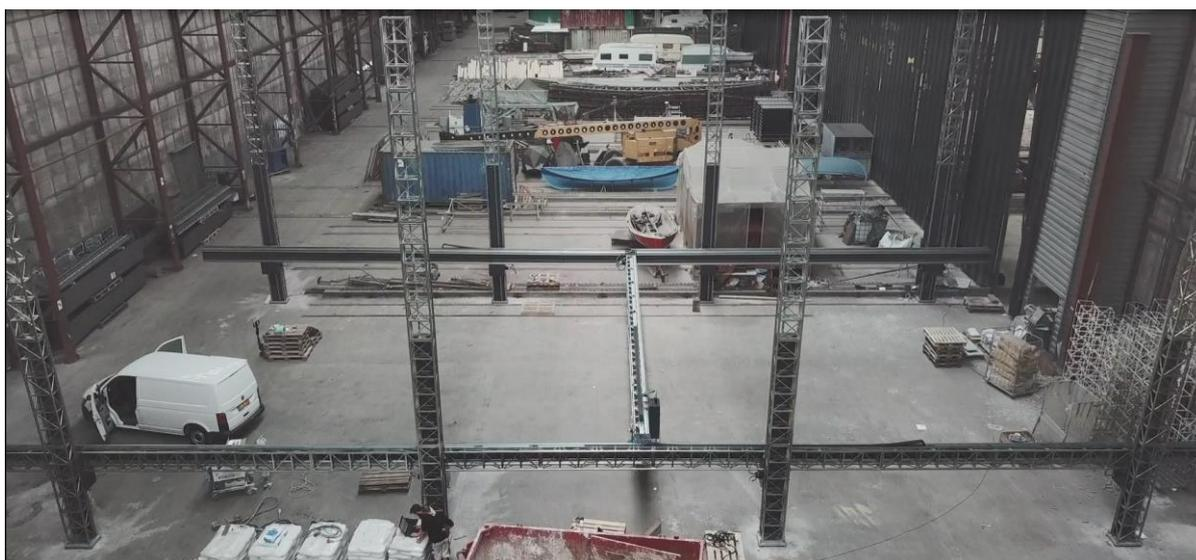
Abbildung 1: Der größte je gebaute 3D-Betondrucker mit einer Grundfläche von mehr als 300m<sup>2</sup> und einer Druckhöhe von fast 9m
