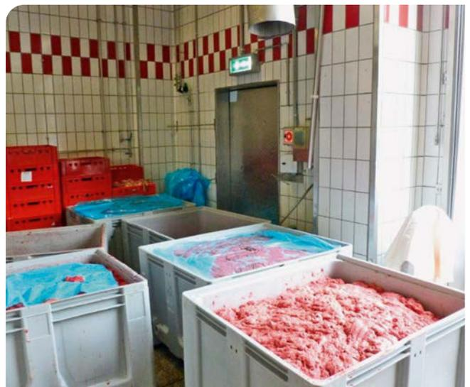
Abbildung 3: Zugestellter Notausgang
