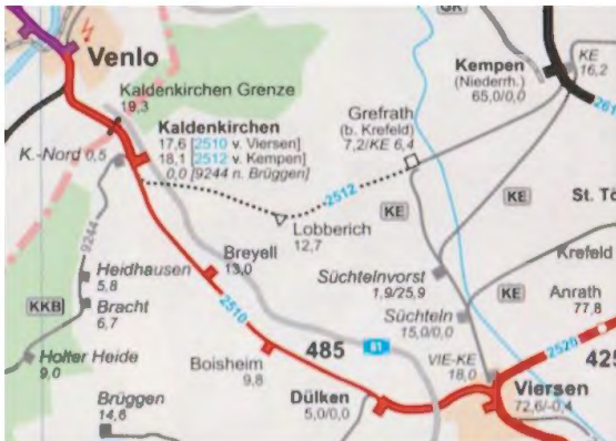
Abb. 2: Eingleisiger Streckenabschnitt Dülken – Kaldenkirchen. Nur diese Karte lässt den Zustand korrekt erkennen. Fast alle anderen Kartenwerke suggerieren einen zweigleisigen Zustand.
