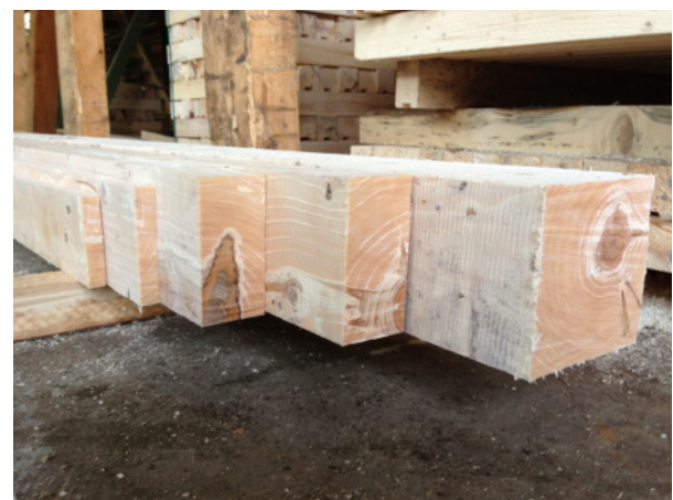
Nobilis eignet sich sehr gut als Schnittholz, da diese Holzart statisch die Vorgaben der DIN 4074-S10 gewährleistet.
