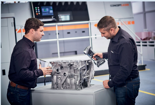
3D-Scan eines Zylinderkurbelgehäuse aus Aluminium (Quelle: Volkswagen AG) mit zeitgleicher Onlineauswertung durch die Robert Hofmann GmbH
